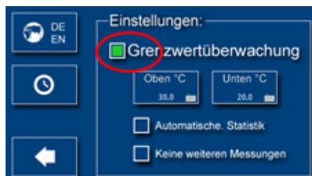
Durch betätigen des Grenzwertüberwachungs-Symbol aktivieren Sie die Temperaturkontrolle.
