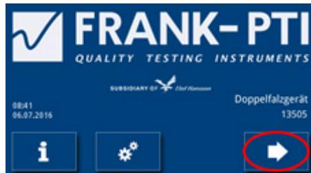
Durch drücken des Pfeil-Symbols oder der Start-Taste gelangen Sie in den Prüfmodus.
