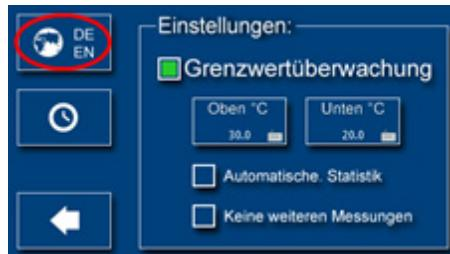
Durch drücken des Sprach-Symbols wechseln Sie die Sprache, der Bildschirm verdunkelt sich bis in allen Bedienmenüs die Sprachumstellung erfolgt ist; kann bis zu 30 Sek. dauern.
