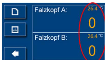
Wird die Grenze unter- oder überschritten wird dies durch einen Farbumschlag gekennzeichnet
