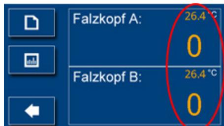
Liegt die Temperatur außerhalb des eingestellten Temperaturbereiches bei aktiver Grenzwertüberwachung, werden die Werte orange markiert.
